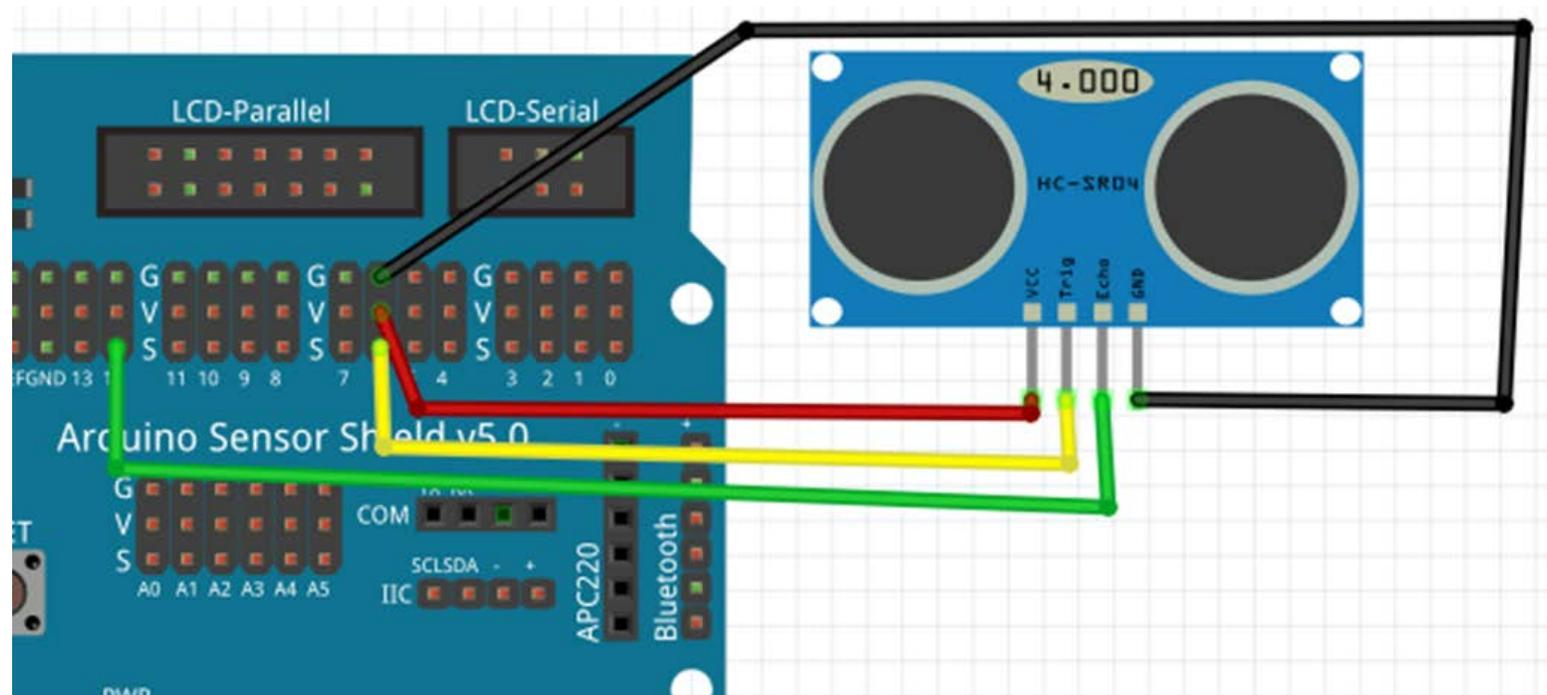
**VCC =V, GND=G, TRIG=S(pin 6) and ECHO=S(pin12)**
